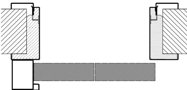
Cerco para puerta corredera VarioFix con desplazamiento delante de la pared
