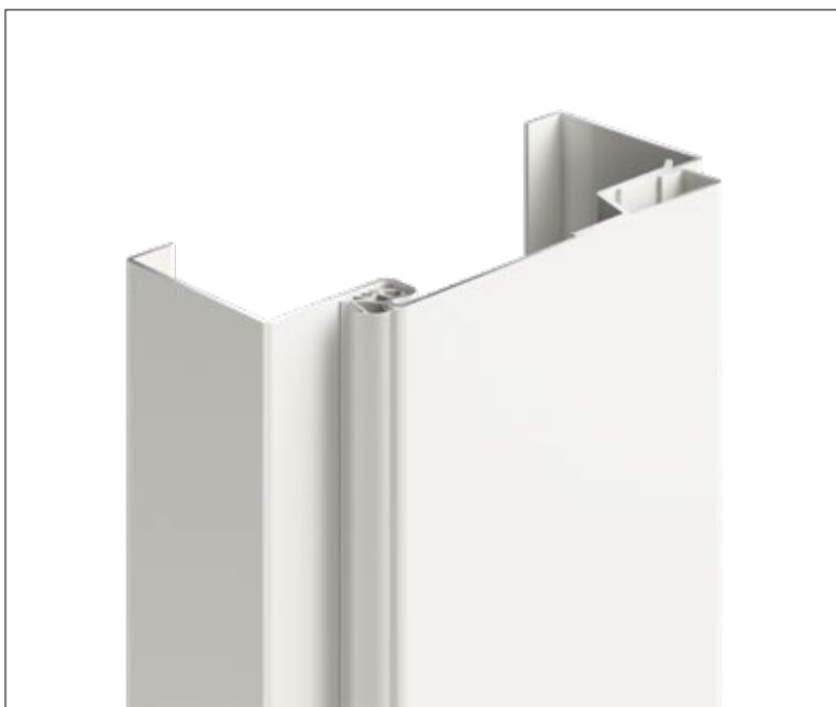
**MONTAJE RÁPIDO.** El cerco de revestimiento de acero VarioFix no solo tiene el aspecto de un cerco de madera, sino que también se monta de la misma manera, aunque hasta un 50% más rápido y sencillo. En lugar de encolar y atornillar por separado el tablero de revestimiento y el marco decorativo, como ocurre con un cerco de madera, en el VarioFix solo se ensamblan la parte del galce y la parte opuesta al galce directamente en la abertura.
